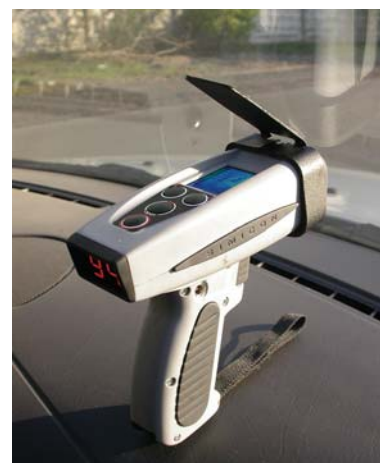
Вариант крепления радара в салоне патрульного автомобиля
