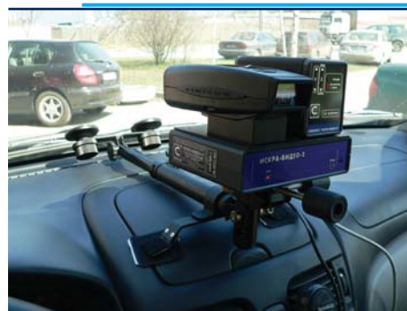
«РАДИС» в составе комплекса видеофиксации «ИСКРА-ВИДЕО-2»КР
