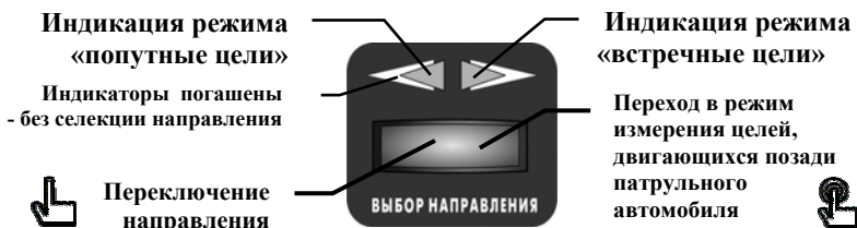
Рис.4. Индикация и выбор направления целей
