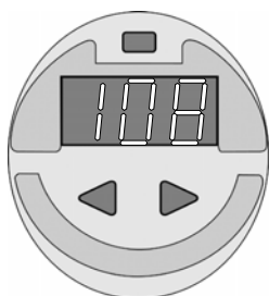
Рис.11. Индикация значения скорости цели
