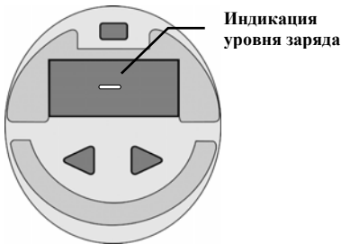
Рис.9. Индикация уровня заряда АКБ
